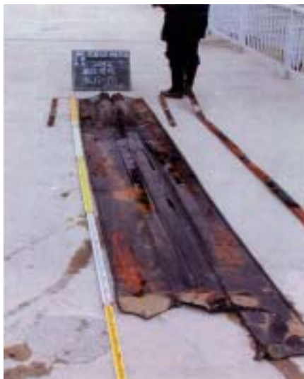
事故箇所の防砂板（写真左）とその破損状況 （「大蔵海岸陥没事故調査報告書」から転載）
