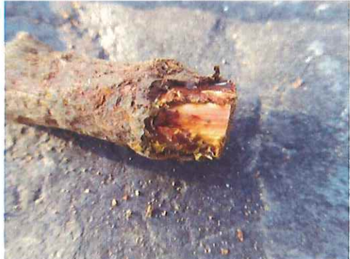
腐朽、分解が始まっている
