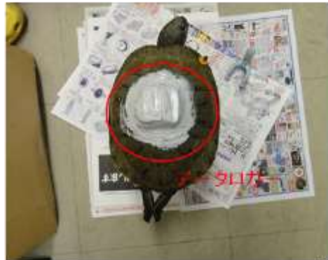
4. 水中ボンドによるデータロガーの装着
