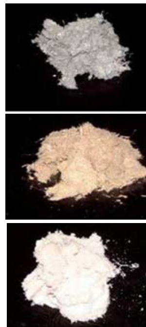
写真 2-2 アスベストの種類 (上)青石綿 (中)茶石綿 (下)白石綿 出典)厚生労働省資料
