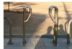
【P型ゲート】上部の突出部分が大型車椅子、ベビーカーなどに引っ掛かって通行できない
