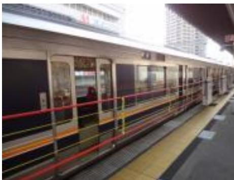
車掌は、ホーム柵を操作盤で「閉」とした後に、車両ドア「閉」とする。
