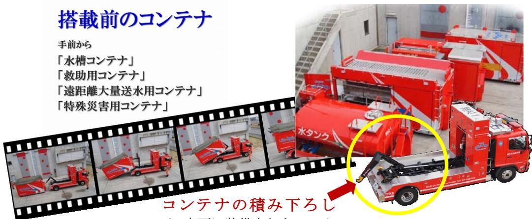
コンテナの積み下ろしは、車両に装備されたフックを利用します。
