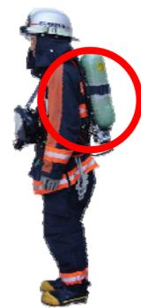
ボンベ内の圧縮空気を調整器で減圧し、面体内に空気を送ります。手で面体内を陽圧にすることにより、有毒ガスの侵入を防ぎます。
