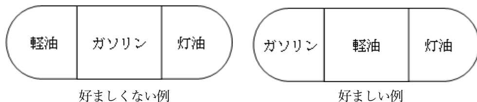
第 10-10 図 ガソリンと灯油を貯蔵する中仕切りタンク
