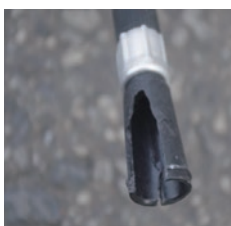
× ノズルの破損
