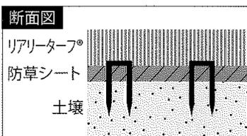
防草シートを曝露時と同じように敷き、スミ付け箇所に専用ピンを1mピッチで打ち、シートを固定します。(1~2本/㎡)
