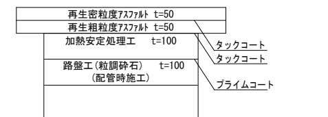
県道車道 As3層式20cm (舗装復旧時)
